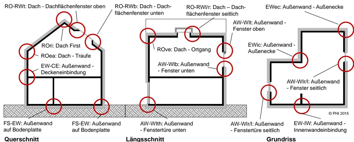
Abbildung 2: Erforderliche Anschlussdetails
